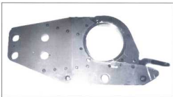
BRONZ YATAĞI DEĞİŞTİRİLEN ÇELİK KONSTRÜKSİYON ÇÖZGÜ LEVENT YATAĞI
